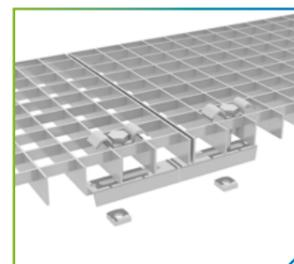
Крепление двух решеток с помощью двойной скобы, состоящее из 2-х верхних частей скоб или тарелок, нижней части зажима, 2-х шестигранных болтов M8, 2-х четырехгранных гаек.
