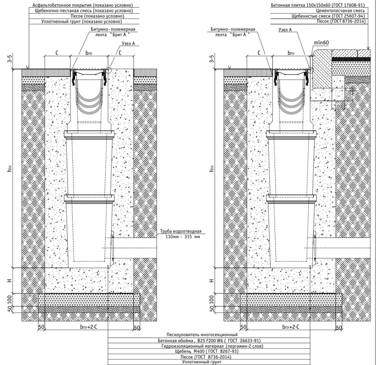
Схема армирования бетонной обоймы лотка водоотводного серии BGZ-S, класс нагрузки E600-F900 для участков с поперечным наездом тяжелого транспорта и повышенной нагрузкой
