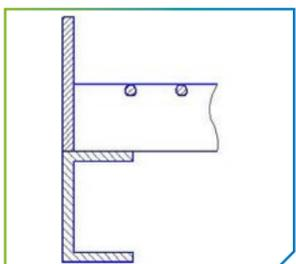
Тип D – высота обрамления значительно больше высоты несущей полосы. Применяется для обрамления решетчатого настила, расположенного по краям площадок технического обслуживания, эстакад и т.д.;
