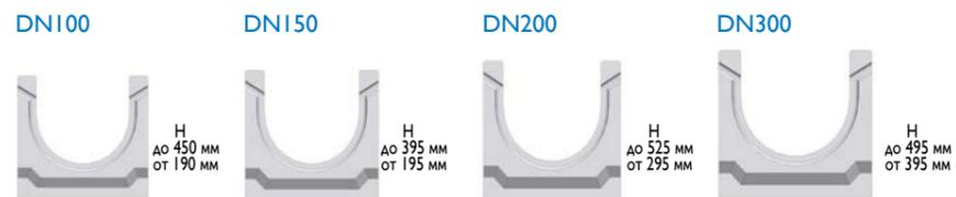
**BGU – толщина стенки 47 мм**
