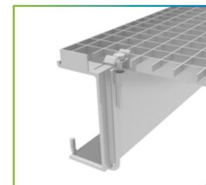
Крепление с помощью крючка, состоящее из верхней части скобы или тарелки, удлиненного крючка из выгнутого круглого прутка с приваренной к нему длинной гайкой в виде гильзы и шестигранного болта M8.
