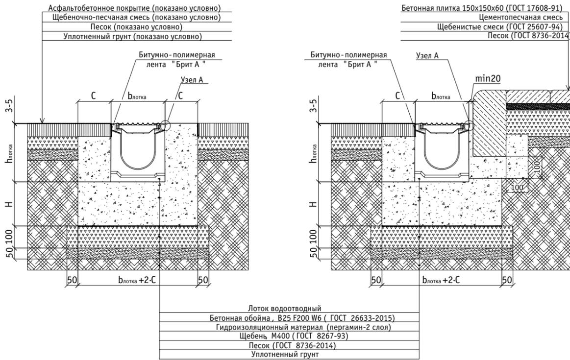
Схема установки бетонного пескоуловителя, класс нагрузки D400-E600
