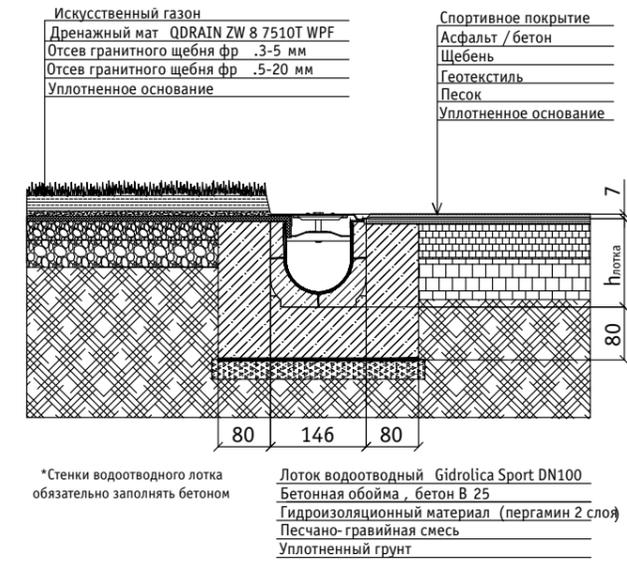
Схема установки пластикового лотка
