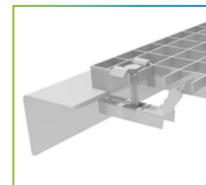
Стандартное крепление, состоящее из верхней части скобы, нижней части – зажима, шестигранного болта M8x60 и четырехгранной гайки M8.
