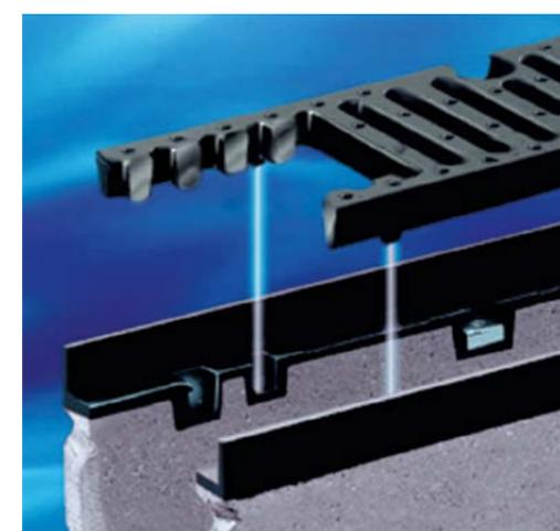
6. Насадки на лотках оснащены специальным пазом, а решетки шипом, которые при совмещении предотвращают продольное смещение решетки. Применение системы «шип-паз» способствует равномерному распределению динамических нагрузок по всей поверхности усиливающей насадки.
