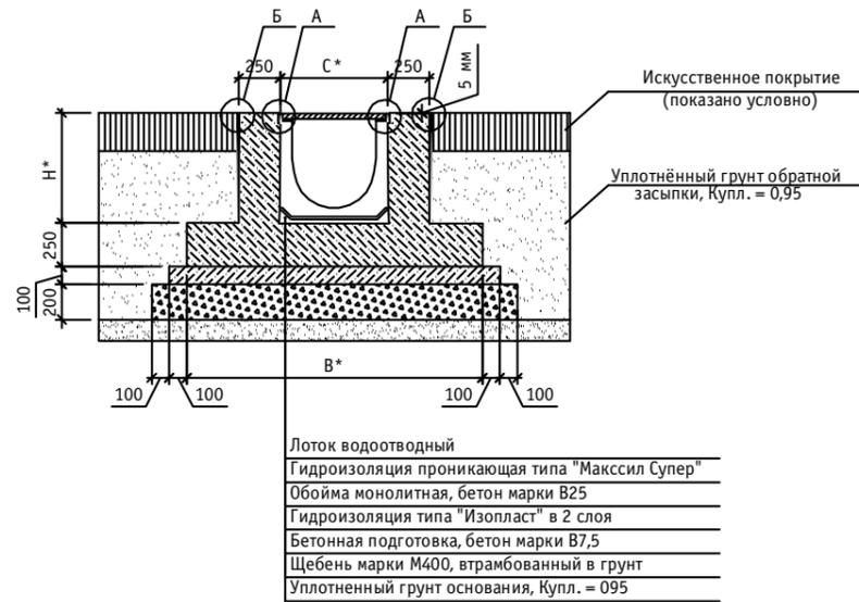
Схема армирования бетонной обоймы лотка водоотводного серии BGM F900
