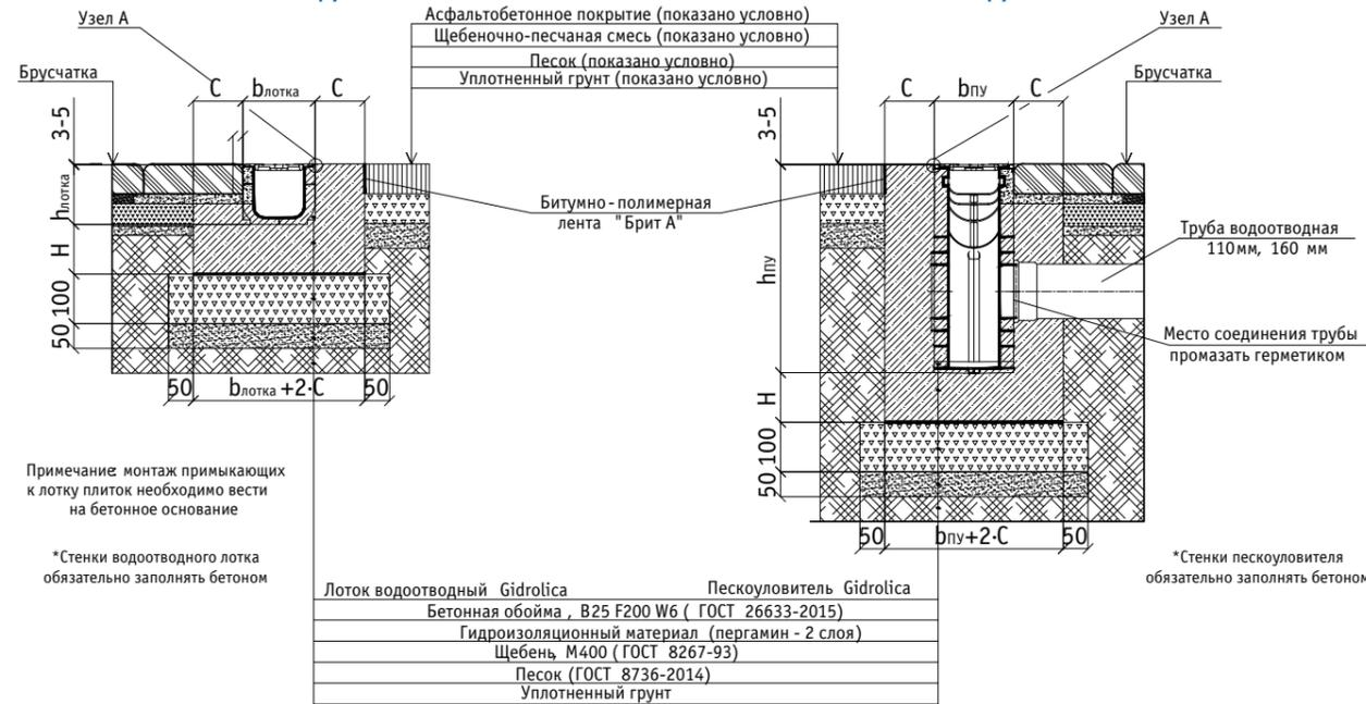
Схема установки пластикового пескоуловителя
