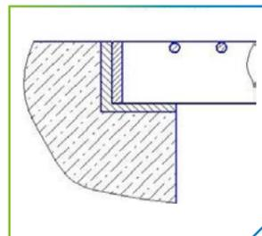
Тип А – высота обрамления равна высоте несущей полосы решетчатого настила;
