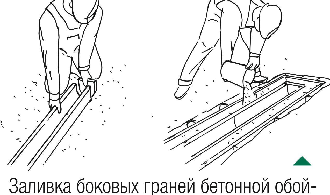
10. Заливка боковых граней бетонной обоймы до уровня подводящей примыкающей конструкции: плитки или асфальта.
