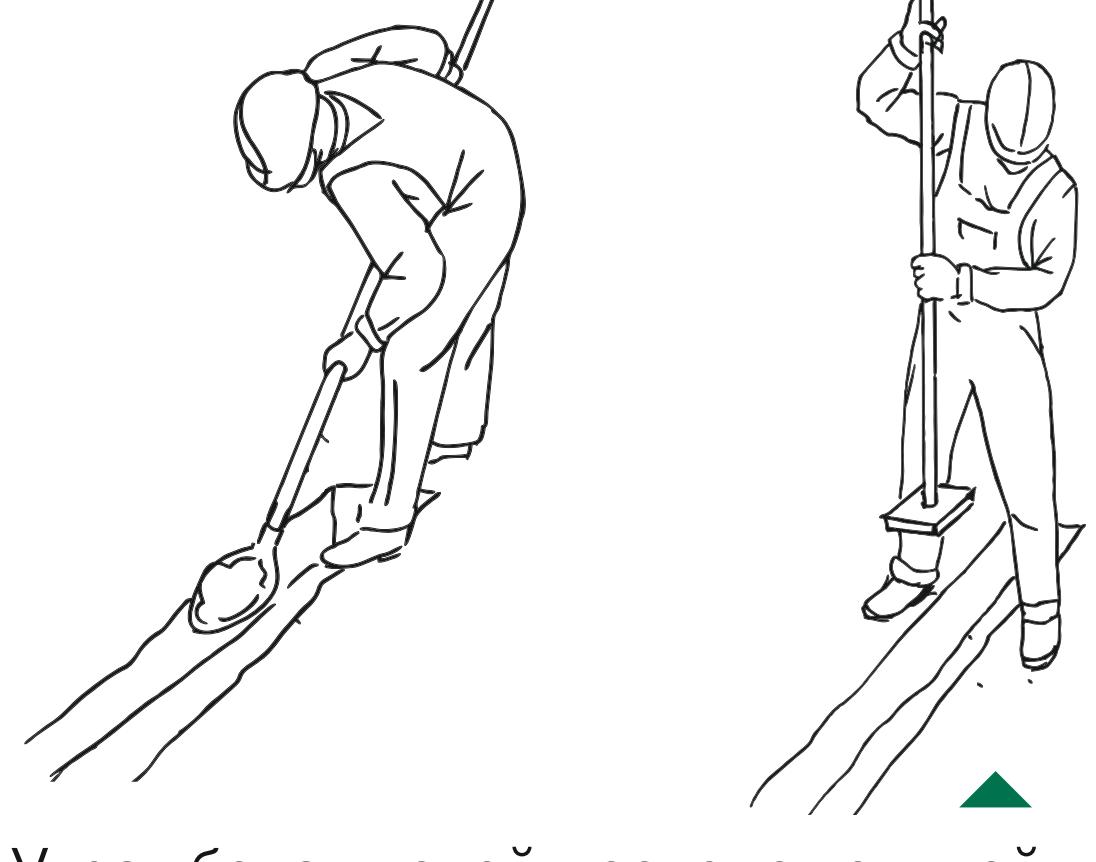
2. Утрамбовать слой пескоцементной смеси высотой **100 мм**.
