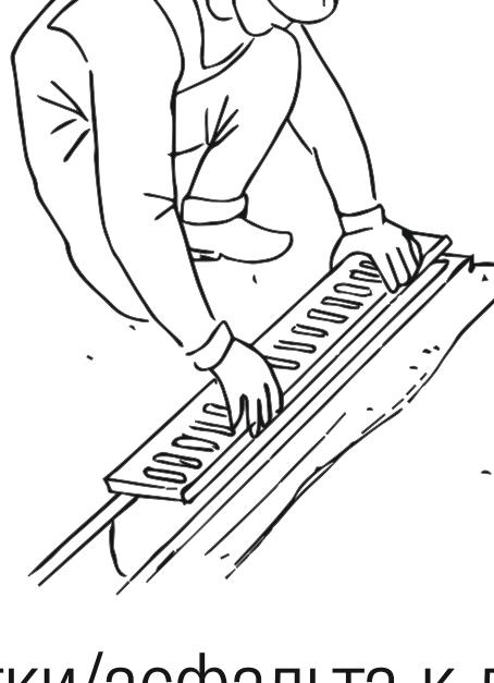
12. Укладка плитки/асфальта к лотку с предварительно установленной возле лотка плоской фанеры для формирования паза для герметизации.
